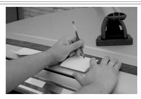
(13) Снимаем молдинг с автомобиля. Сверлим отверстия. Сверление для точности выполняем в два этапа: сначала сверлом 3-4 мм, потом сверлом диаметром 7-8 мм.
