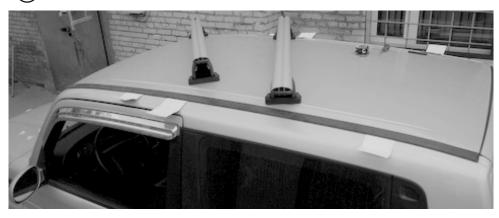
(12) Сложите разметочную карточку пополам по линии сгиба. Внимание: карточка должна располагаться строго горизонтально относительно земли, в противном случае разметка отверстий в молдинге будет НЕ СОВПАДАТЬ с отверстиями закладных. Ручкой или маркером размечаем отверстия на молдинге
